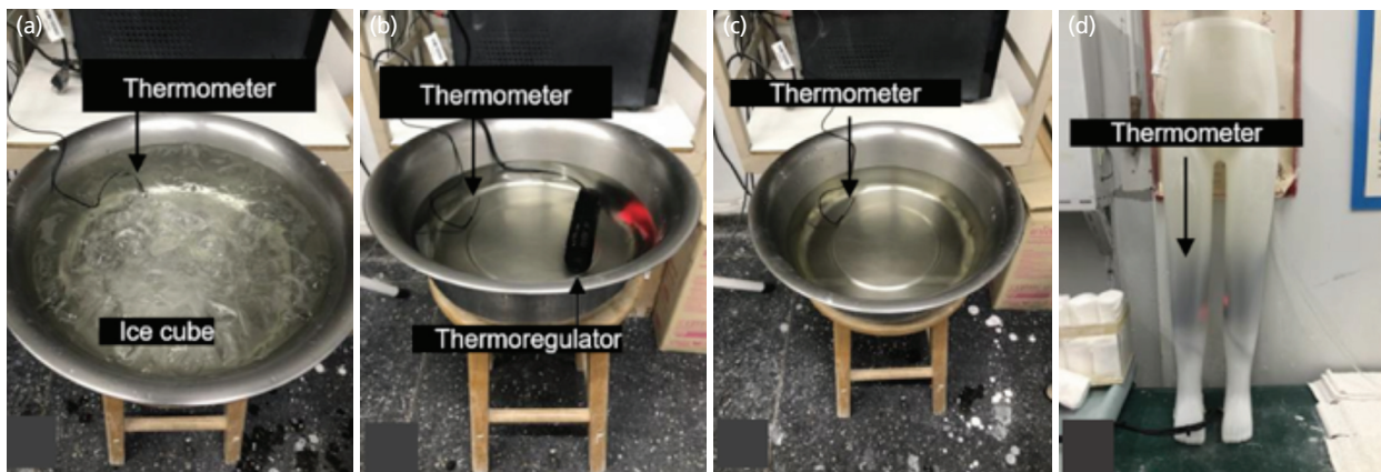
Fig. 2: (a) Cold water, (b) hot water, (c) room-temperature water, and (d) leg mannequin.
